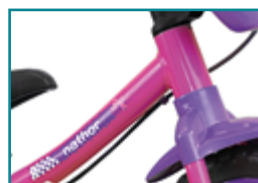
Quadro, garfo e guidão em aço carbono
