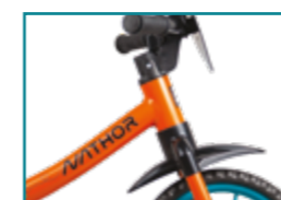
Quadro, garfo e guidão em aço carbono
